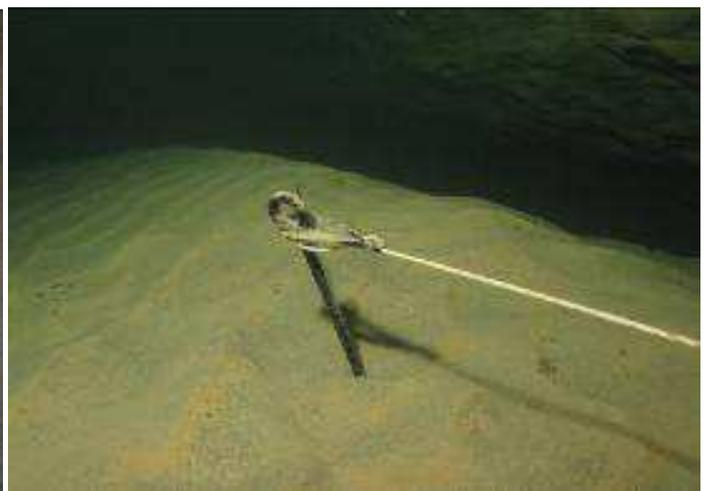
*Foto 6a e 6b – Elemento modulare per la sagolatura su fondali limoso sabbiosi*
