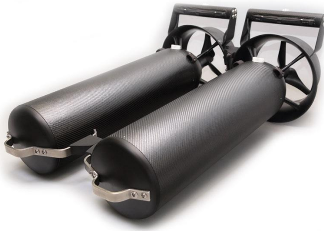
Fig. 1 l'ultima generazione degli scooter prevede una scocca in carbonio e la possibilità di abbinarli (TWIN) da http://www.carbon-scooter.com
